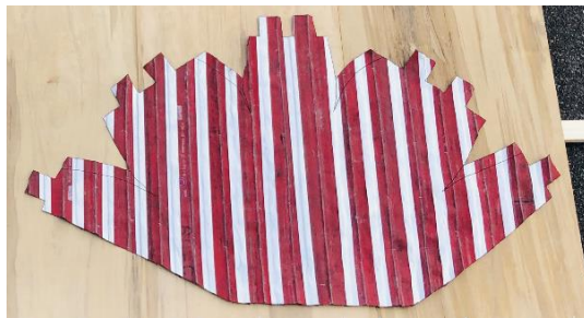
「写真4 型枠を「A帯」に書き出した後に切り出し」
